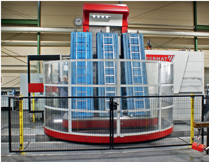
4 Aus Gründen der Sicherheit wurde der Drehtisch mit einer Vollverkleidung geordert. Die Spannwinkel hat man bei TS Techno selbst gebaut. Auch kleinere Teile können darauf sicher für die Bearbeitung gespannt werden © Andrea Jäger
